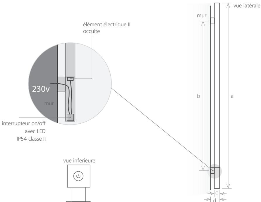
Version électrique: dans la position horizontale la profondeur est de 80mm.
