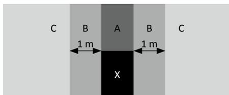
Zone «X» est la source de l'eau (lavabo, douche, baignoire, WC etc.) Lors du montage du radiateur dans la zone «A» ou «B», afin de garder la garantie Fabricant, il est indispensable de commander l'appareil couvert d'une couche du zinc, disponible dans l'offre du Fabricant. Zone «C» signifie la zone où le montage des radiateurs de peinture standard est admis en toute sécurité.
