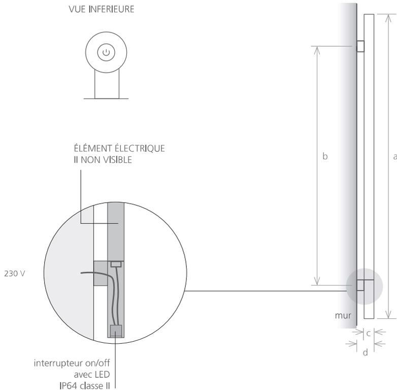
Version électrique: dans la position horizontale la profondeur est de 82mm
