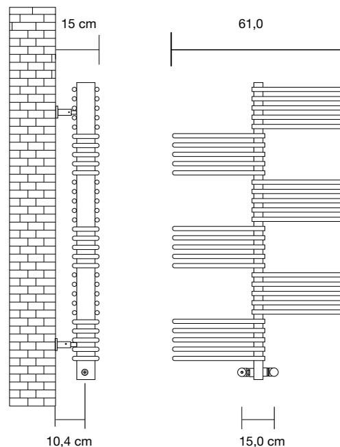
Entraxe raccordements avec mesures se référant aux vannes Tubes
