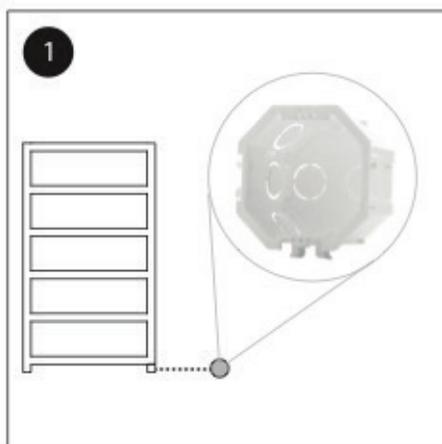
1 Effectuer une ouverture dans le mur pour colloquer la boîte en plastique pour l'interrupteur.
