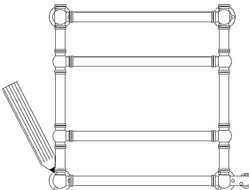
3- Eseguire i fori a muro e a pavimento, poi inserire i tasselli in dotazione/ Run the wall and floor holes, then insert the supplied dowels/ Запустите отверстия для стен и пола, затем вставьте прилагаемые дюбеля.
