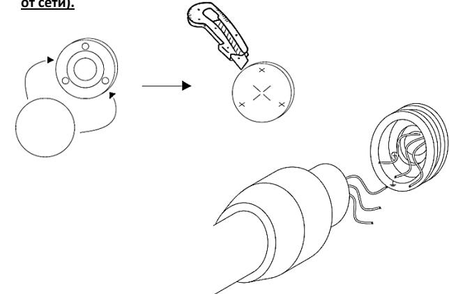
7- Fissare l'articolo serrando i grani e infine mandare a battuta i rosoni (**Attenzione! Solo dopo questa operazione si può riattivare la rete elettrica!**)/ Secure the article by tightening the grains and finally sending the rosettes up (**Attention! Only after this operation you can turn on the power supply!**)/ Закрепите изделие, затянув зерно и, наконец, поместите розеточки вверх (**Внимание! Только после этой операции вы можете включить источник питания!**)
