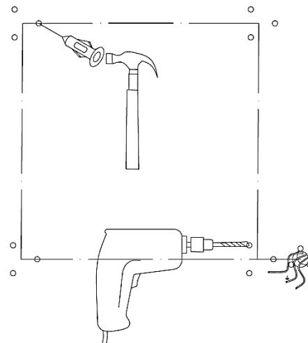
4- Fissare le flange a muro in dotazione ed avvitare i raccordi su di esse (solo per quelle a muro), compresa quella per il box che non avrà raccordo/ Fix the supplied flanges and screw the fittings on them (only for wall mounts), including that for the box that will not fit/ Закрепите прилагаемые фланцы и завинтите фитинги на них (только для настенных креплений), в том числе для коробки, которая не подходит
